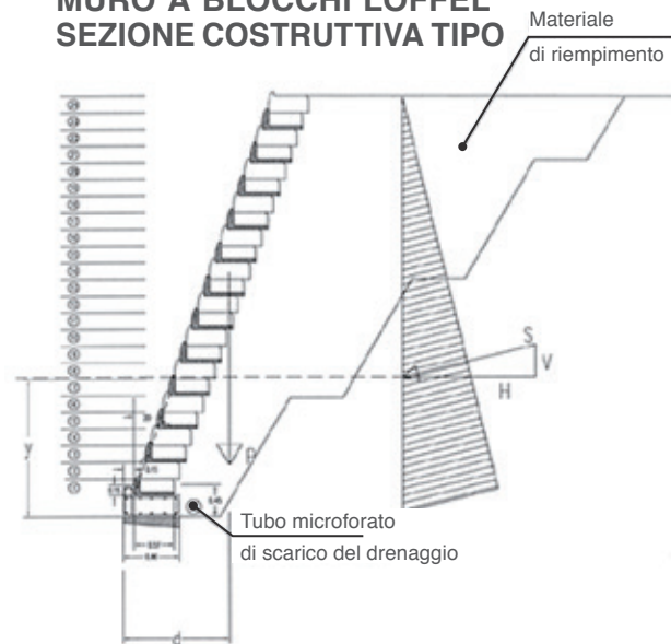
Schema di trasferimento dei carichi tra le file di blocchi e tra i blocchi e la fondazione
